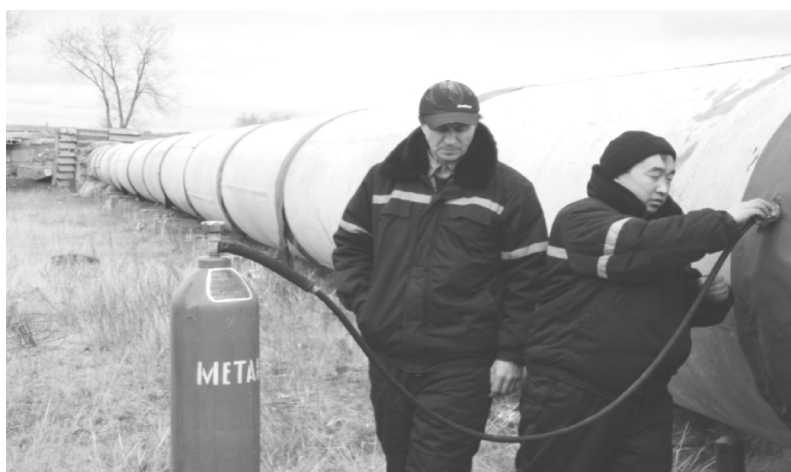
Рисунок 1. Момент загазирования ударной трубы метаном
