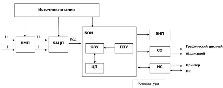
В схеме представлены следующие сокращения: БМП — блок масштабных преобразователей; БАЦП — блок аналогово-цифрового преобразования; БОИ — блок обработки информации; ОЗУ — оперативно запоминающее устройство; ЦП — центральный процессор; ПЗУ — постоянно запоминающее устройство; ЭНП — энергонезависимая память; СО — средство отображения; ИС — интерфейс связи; АЦ — алфавитно-цифровой дисплей
