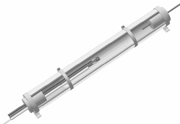
Рисунок 13. Устройство высокотемпературной ячейки для измерения электрофизических параметров синтезированных твердых электролитов в газовых атмосферах
