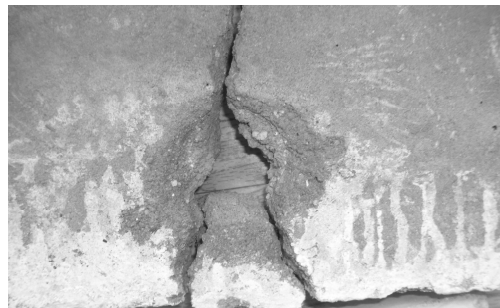
Рисунок 6. Разрыв камня после бурения в течение 5 минут ( h = 40 мм)
