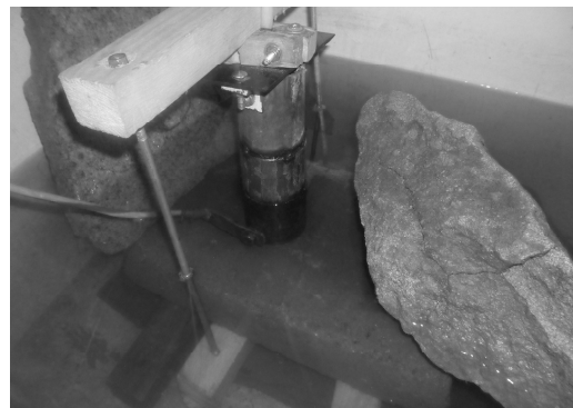
Рисунок 3. Рабочая ячейка, закрепленная на камне
