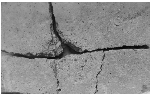
Рисунок 5. Разрыв камня после бурения в течение 3 минут ( h = 30 мм)
