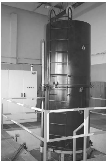
Рисунок 4. Установка УА-63-950/3000 с изменяемой геометрией рабочей камеры
