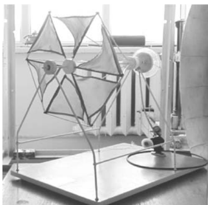
Рисунок 3. Модель ветротурбины с динамически изменяемой формой поверхности лопастей
