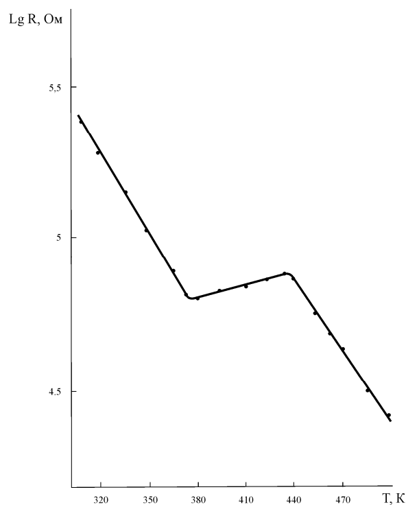
Рисунок 2. Зависимость сопротивления от температуры для феррита кальция \text{YbCaFe}_2\text{O}_{5,5}
