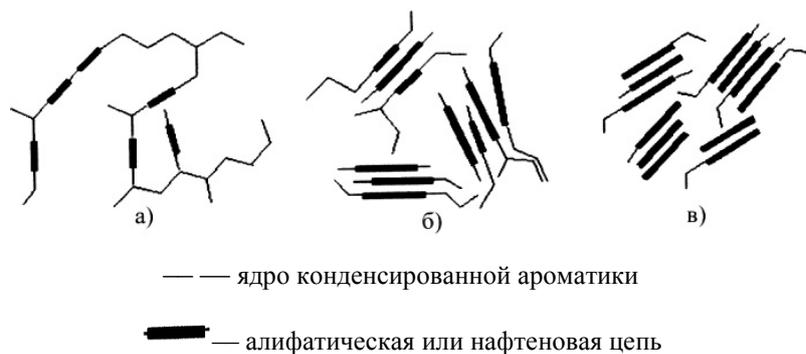
Рисунок 4. Структура углей низшей (а), средней (б) и высшей (в) степени углефикации
