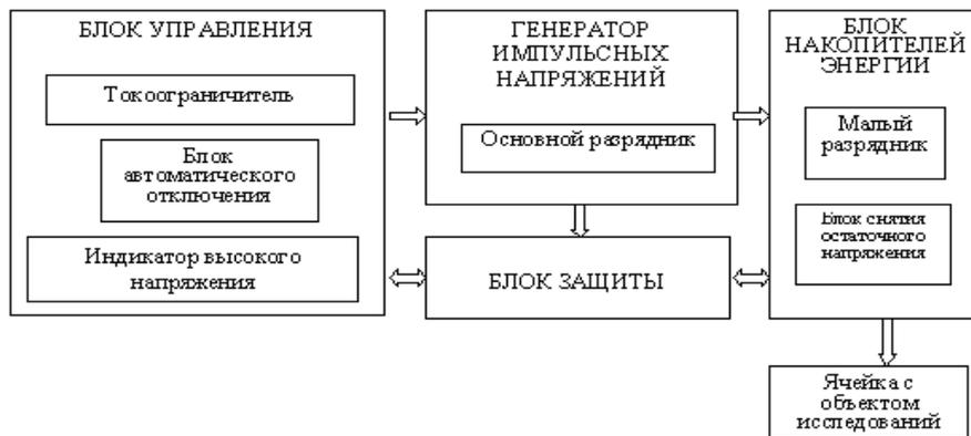
Рисунок 1. Блок-схема электрогидроимпульсной установки
