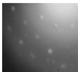
Рисунок 3а. Картина микродифракции электронов в зоне реакции никеля и титана [3];
