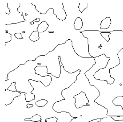
Рисунок 4. Фрактальная структура покрытия Zn-Al
